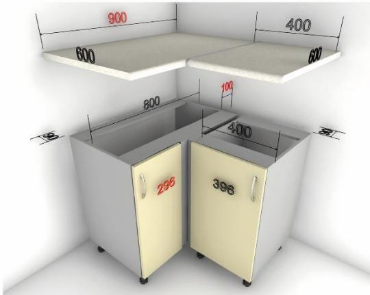
Детальний вигляд кутового сполучення модулів НЦ-80/82/1\*(НЦМ-80/82/1\*) НЦ-80/82/2\*\*\*(НЦМ-80/82/2\*\*\*)
